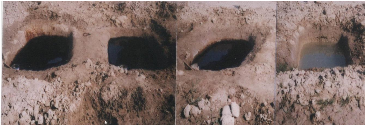
شكل رقم (1). أحواض التجربة في موقع مركز علوم البحار جامعة البصرة : ( 1 ) حوض السيطرة و ( 2 ) حوض النفط حجم 1.2 لتر و ( 3 ) حوض النفط حجم 2.4 لتر و ( 4 ) حوض النفط حجم 3.6 لتر .
