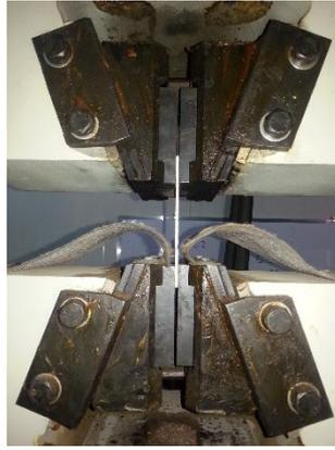
**Fig. 3. Tensile test grips**
