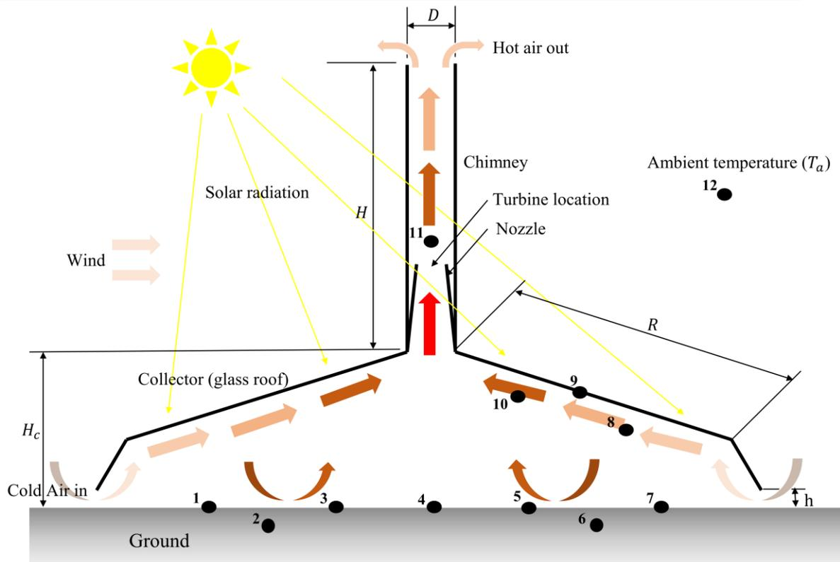
**Fig. 3. Thermometer node positions**
