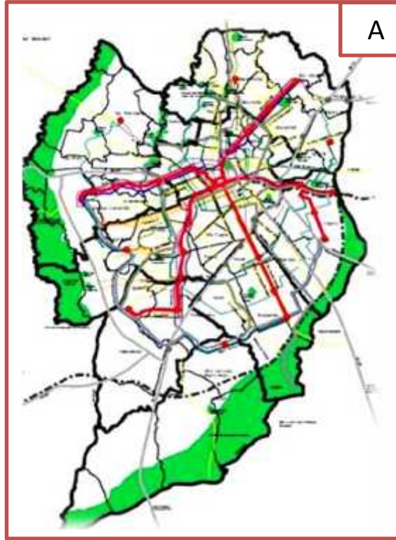
الشكل (٣): (A) يوضح محاور النقل الخمسة في مدينة كوريتيبيا موضحة باللون الاحمر (٣٧) ، (B) صورة توضح مسار ومحطات وقوف الحافلات في مدينة كوريتيبيا (٣٨)
